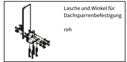
Zusatzlasche Dachsparren 60 × 260 × 12 mm
